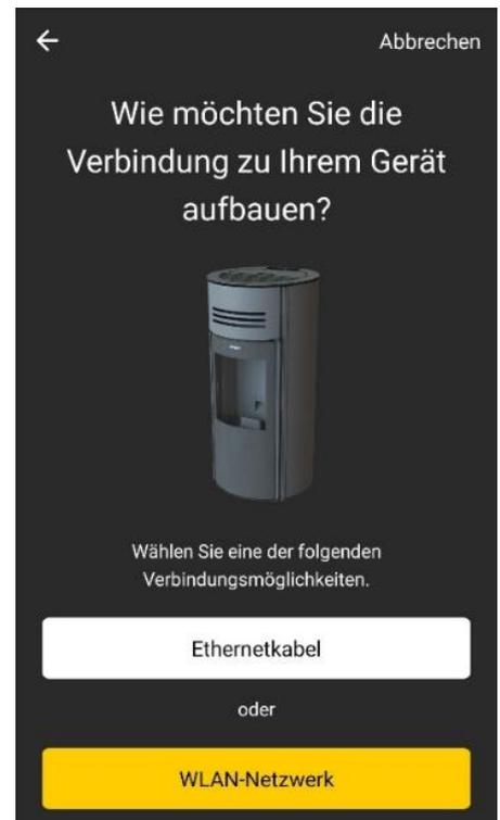
Sollten Sie den Ofen mit einem LAN-Kabel direkt mit dem Router verbinden, wählen Sie stattdessen „Ethernetkabel“ und scannen Sie den QR-Code auf dem kleinen Aufkleber auf der Rückseite des Ofens. Gehen Sie in diesem Fall direkt zu Punkt 8.
