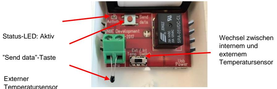
A) Entfernen Sie die Abdeckplatte und setzen die Batterien ein. Die Status-LED muss nun blinken. Der Raumtemperatursensor ist mit einem internen und einem externen Temperatursensor ausgestattet. Sorgen Sie immer dafür, dass der Raumtemperatursensor eingestellt ist, den internen Sensor zu nutzen. Dies tun Sie über den kleinen Schalter unten an der Steuerplatine, wo „Ext / Int“ geschrieben steht. Der Schalter muss auf „Int“ stehen.
