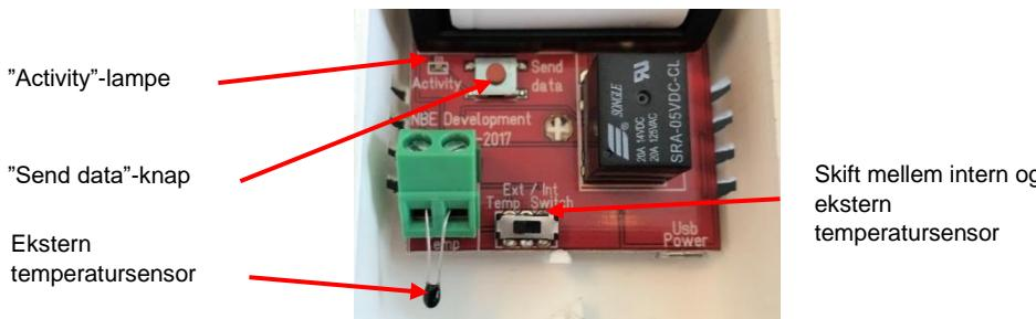
A) Tag det yderste skjold af rumtemperatursensoren og sæt batterier. Tjek nu, at "activity"-lampen blinker. Se billede ovenfor. Rumtemperatursensoren er udstyret med en ekstern og en intern temperatursensor. Sørg altid for, at rumtemperatursensoren er indstillet til at bruge den interne sensor. Dette gøres på den lille knap nederst på printet, hvor der står "Ext / Int". Knappen skal stå på "Int."
