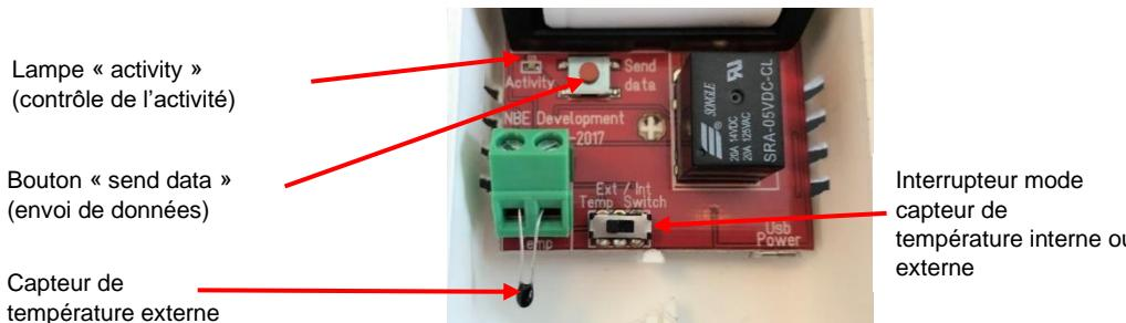
A) Enlevez le blindage externe du capteur de température ambiante et insérez les piles. Vérifiez si la lampe « activity » clignote (voir photo ci-dessus). Le capteur de température ambiante est équipé d'un capteur externe et interne. Assurez-vous que le capteur de température ambiante soit toujours réglé pour utiliser le capteur interne. Vous pouvez le choisir en bas de la carte mère, où vous pouvez basculer entre "Ext / Int". Le bouton doit toujours être sur « Int ».
